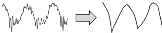
Figura 5.2-2 Un ejemplo de una señal de medición del sensor con ruido (izquierda) y los mismos datos después de eliminar el ruido mediante suavizado (derecha).
