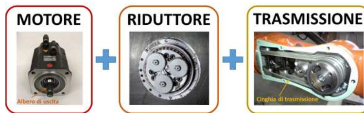
Figura 8.3-4 Esempi di motore elettrico, riduttore epicicloidale e trasmissione a cinghia di un robot*. Diritti di immagine: Dr. Arun Dayal Udai.
